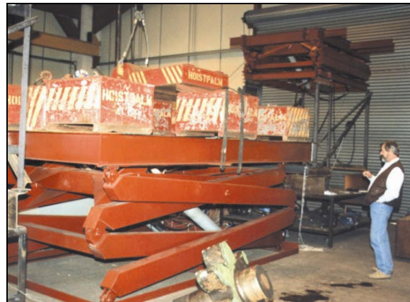
Mynd 16: Sviðslyftur. Prófun lyfta hjá framleiðanda.
